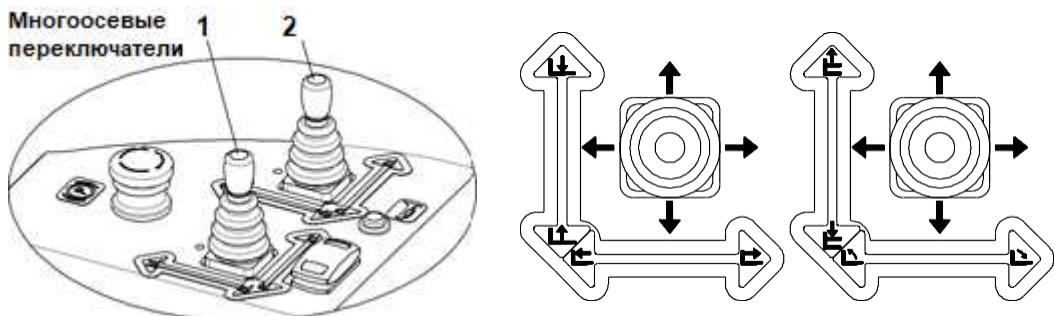
1. Ручка подъема: предназначена для управления подъемом и спуском вил. При тяге многоосевого переключателя 1 в сторону «на себя» вилы будут подниматься. При нажатии «от себя», вилы опускятся.
