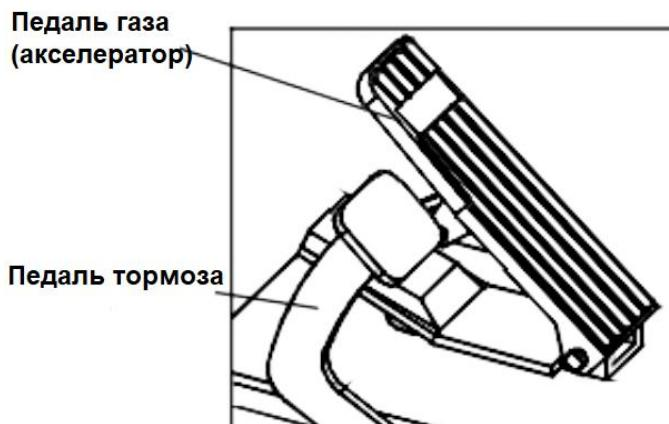
Используется для управления грузовиком в момент старта, разгона, движения и торможения. При медленном нажатии на акселератор автомобиль будет двигаться и разгоняться пропорционально нажатию педали. Чем ниже будет нажат
