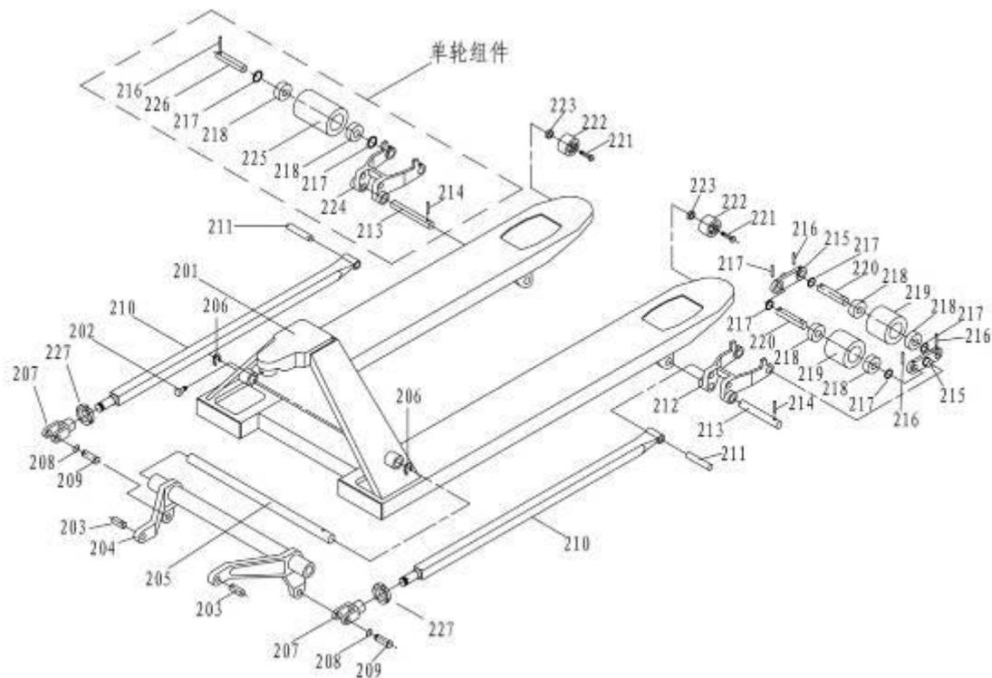
Рисунок 6. Взрыв-схема корпуса тележки AC/LC/SD.
